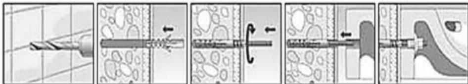
Рис. 1 – Крепление раковины к стене с помощью специального монтажного комплекта
